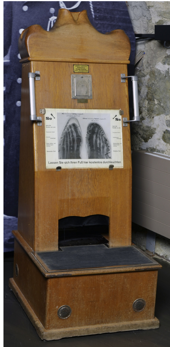
Abbildung 1. Pedoskop Ernst Gross Röntgenapparate, Calw 1949. Bildquelle: Archiv Deutsches Röntgen-Museum.
