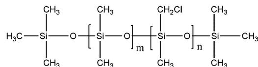
**Scheme 1.** Structures of PCMS ( $m=0, n \neq 0$ ), PDCMS ( $m \neq 0, n \neq 0$ ), PDMS ( $m \neq 0, n=0$ ).
