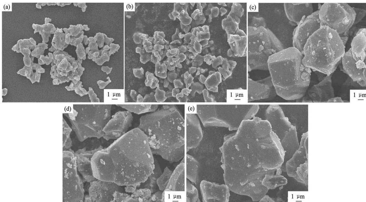
Fig. 2 SEM images of undoped AION (a), AION:1.6 mol.% $Er^{3+}$  (b), AION:1.6 mol.% $Er^{3+}$ , 2.6 mol.% $Yb^{3+}$  (c), AION:1.6 mol.% $Er^{3+}$ , 3.1 mol.% $Yb^{3+}$  (d) and AION:1.6 mol.% $Er^{3+}$ , 3.6 mol.% $Yb^{3+}$  (e)
