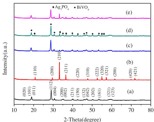
**Fig. 1.** XRD patterns of the prepared BiVO<sub>4</sub> (a), Ag<sub>3</sub>PO<sub>4</sub> (b), Ag<sub>3</sub>PO<sub>4</sub>/BiVO<sub>4</sub>-10 (c), Ag<sub>3</sub>PO<sub>4</sub>/BiVO<sub>4</sub>-5 (d) and Ag<sub>3</sub>PO<sub>4</sub>/BiVO<sub>4</sub>-3 (e).
