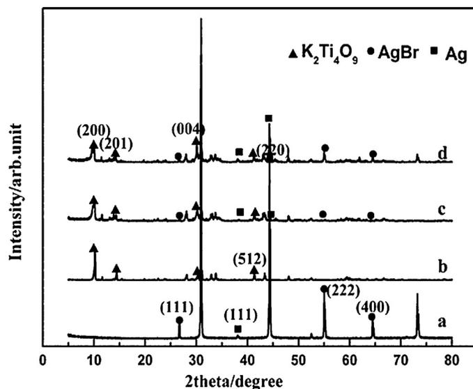
Fig. 1. XRD patterns of (a)  $Ag@AgBr$ , (b)  $K_2Ti_4O_9$ , (c) 10 wt.%  $Ag@AgBr/K_2Ti_4O_9$  and (d) 20 wt.%  $Ag@AgBr/K_2Ti_4O_9$ .
