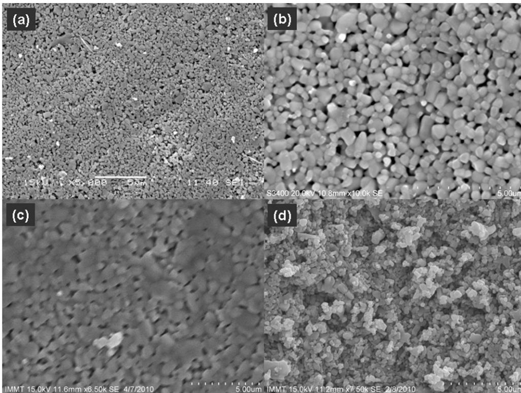
**Fig. 2.** SEM pictures of  $Zn_{1-x}Co_xO$  system ((a)  $x = 0.03$ ; (b)  $x = 0.05$ ; (c)  $x = 0.07$ ; and (d)  $x = 0.1$ ).
