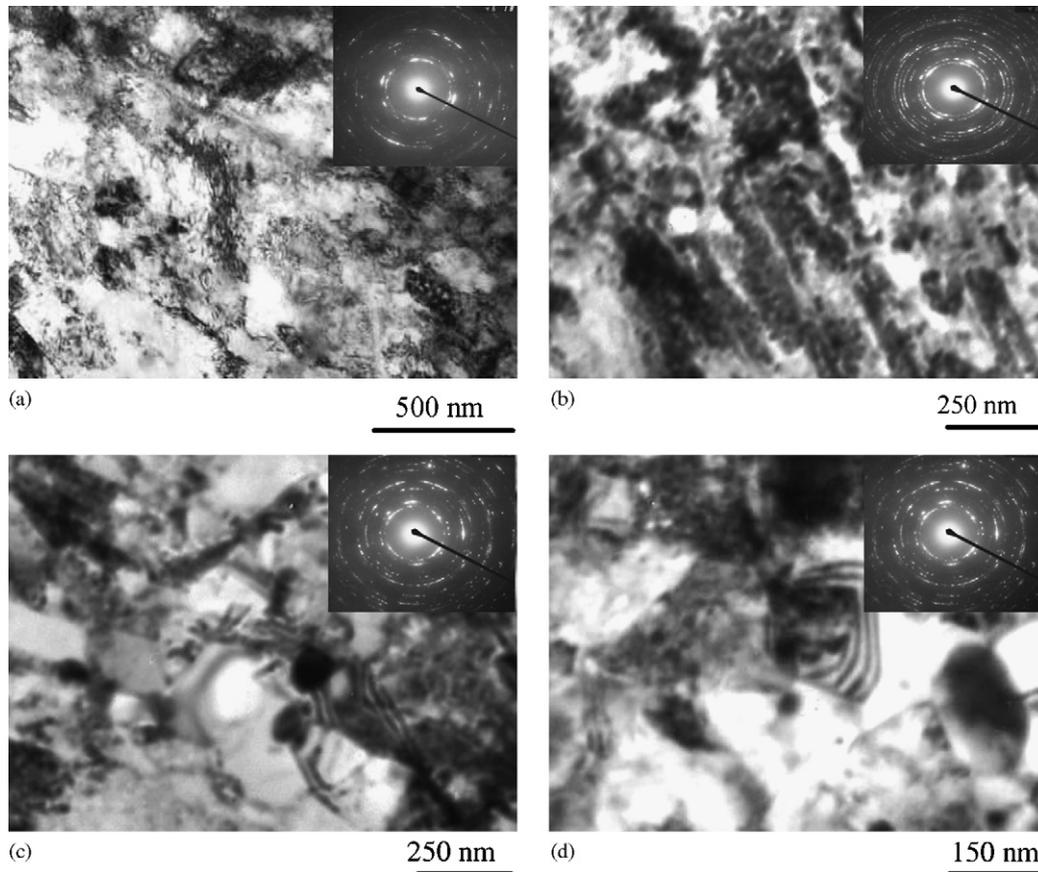
Fig. 1. TEM images after ECAP and subsequent heating. (a) ECAP,  $N=4$ , (b) ECAP +  $T=550\text{ }^{\circ}\text{C}$ , 30 min, (c) ECAP +  $T=550\text{ }^{\circ}\text{C}$ , 30 h and (d) ECAP +  $T=600\text{ }^{\circ}\text{C}$ , 30 min.
