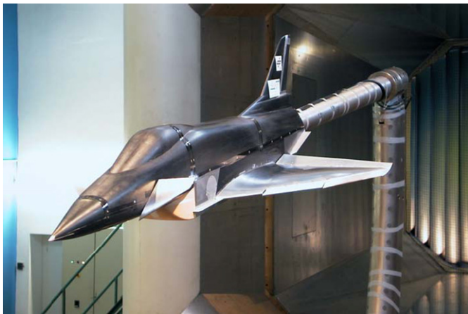
Fig. 1. X-31 model in rear sting configuration in DNW Low-Speed-Wind-Tunnel Braunschweig (DNW-NWB) (photo by courtesy of Deutsches Zentrum für Luft- und Raumfahrt, DLR).
