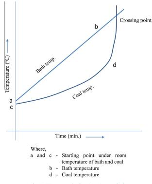
Fig. 1. CPT curve under linear heating rate [28].
