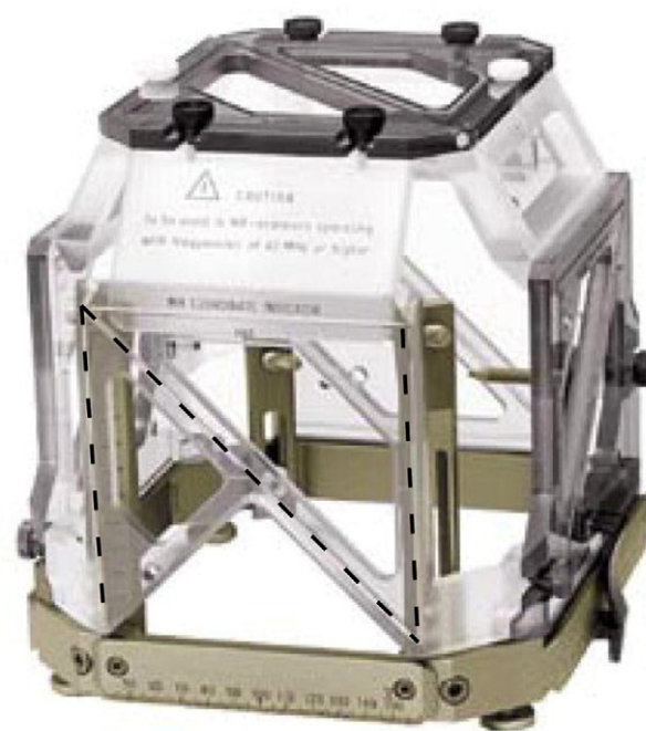
Fig. 2. Boîte des repères fiduciels pour IRM fixée sur la base du cadre Leksell (Elekta Instrument, Stockholm, Suède). Noter la forme en N des repères fiduciels tubulaires mises en évidence par les lignes pointillées noires. Deux lignes fiducielles ont une direction verticale et la troisième une direction oblique.
