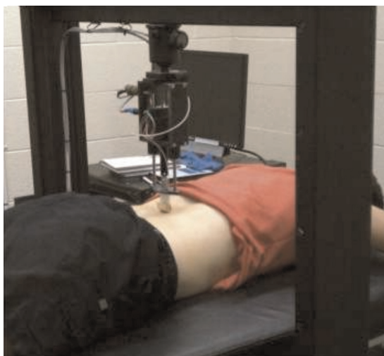
Figure 2. Instrument mécanique servant à l'évaluation manuelle de la raideur rachidienne ([1]).
