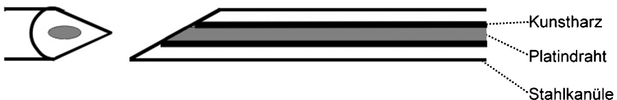
Abb. 1. Schematischer Aufbau einer konzentrischen Nadelelektrode. Die Ableitfläche ist an der schräg angeschliffenen Nadel als „ovale Fläche“ erkennbar. Zwischen Kanüle und Platindraht wird ein Kunstharz als Isolationsschicht verwendet
