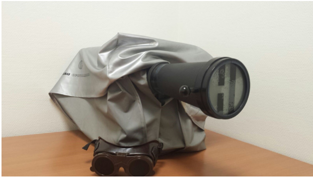
Figure 1. Scotoptomètre de Beyne et lunettes occultantes.
