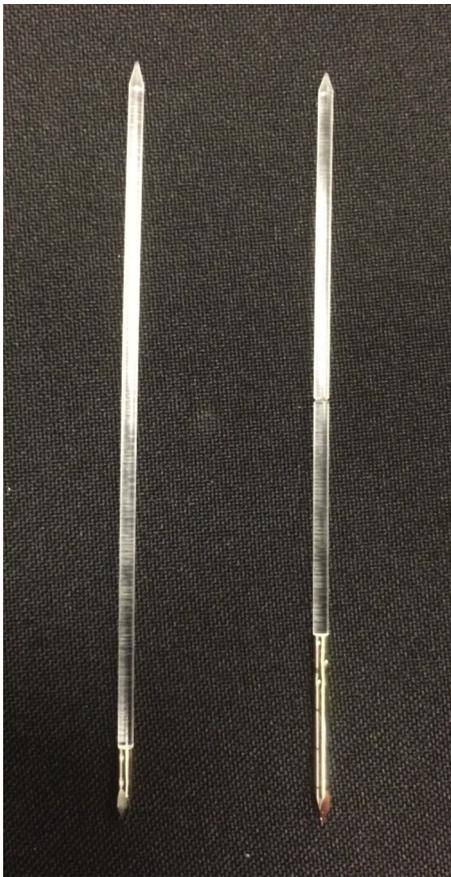
Abb. 1. Biodegradierbare Pins aus PLA
