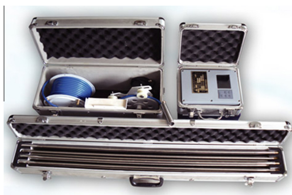
Fig. 2. Borehole video instrument (Ver.TYGD20).
