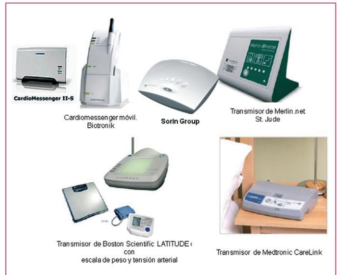
**Figura 1.** Transmisores para monitorización a distancia de dispositivos de estimulación cardíaca de las diferentes empresas.
