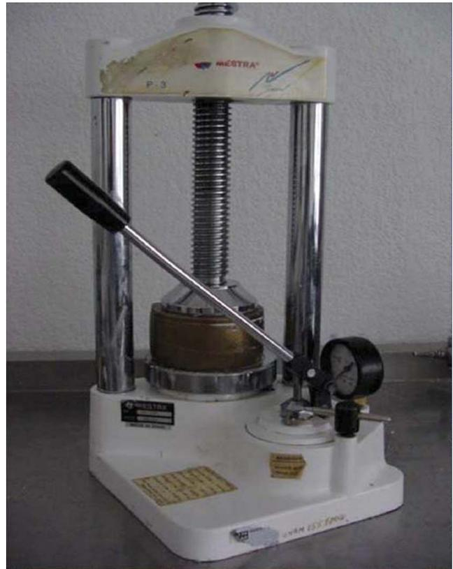
**Figura 2.** Se observa la prensa que se utilizó, en donde la mezcla de acrílico se prensó a 10 lb/in<sup>2</sup>.
