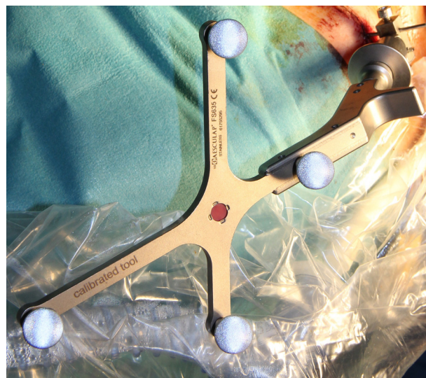
Figure 2. Corps rigide équipé des boules réfléchissant les rayons infrarouges émis par la caméra.
