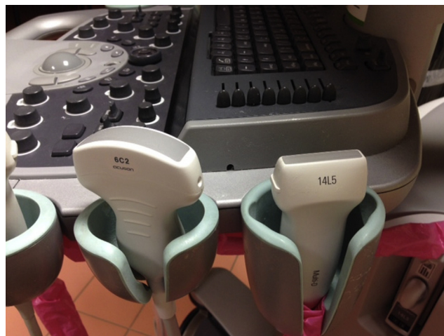
Ryc. 1 – Głowica convexowa i liniowa Fig. 1 – Head convex and head Line
