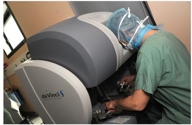
**Figure 2.** Le chirurgien dirige les bras du robot depuis une console située à distance de la table d'opération.
