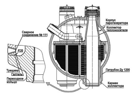
Сварное соединение № 111 = Welded joint 111 Корпус парогенератора = Steam generator vessel Коллектор теплоносителя = Coolant header Трещина = Crack Галтель = Fillet Переходное кольцо = Adapter ring Патрубок Дн 1200 = Dn1200 nozzle Карман коллектора = Headerpocket
