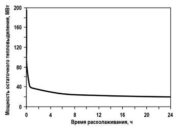
Мощность остаточного тепловыделения, MBT = Decay heat power, MW Время расхолаживания, y = Cooldown time, h
