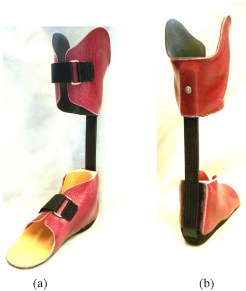
Fig. 1. The carbon fiber spring orthosis (SO): (a) anterior view and (b) posterior view.
