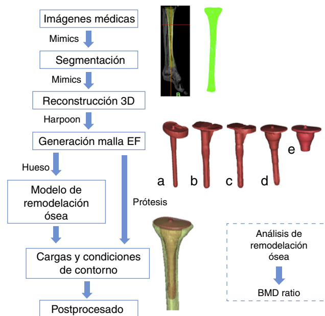
Figura 1 Proceso seguido para la reconstrucción y análisis por el método de los elementos finitos partiendo de las imágenes médicas. a) Vástago recto. b) Vástago con offset sin suplemento. c) Vástago en offset con suplemento. d) Vainas con vástago. e) Vainas sin vástago.
