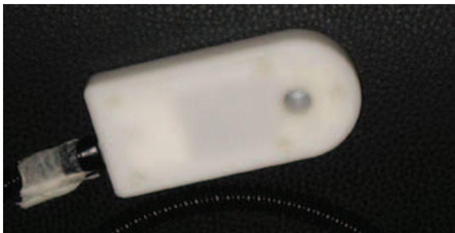
Fig. 1 : Antenne de surface spécifique "3 inch" utilisée pour l'étude de la peau. Model of dedicated 3-inch (7,5 cm) coil used for study of the skin.
