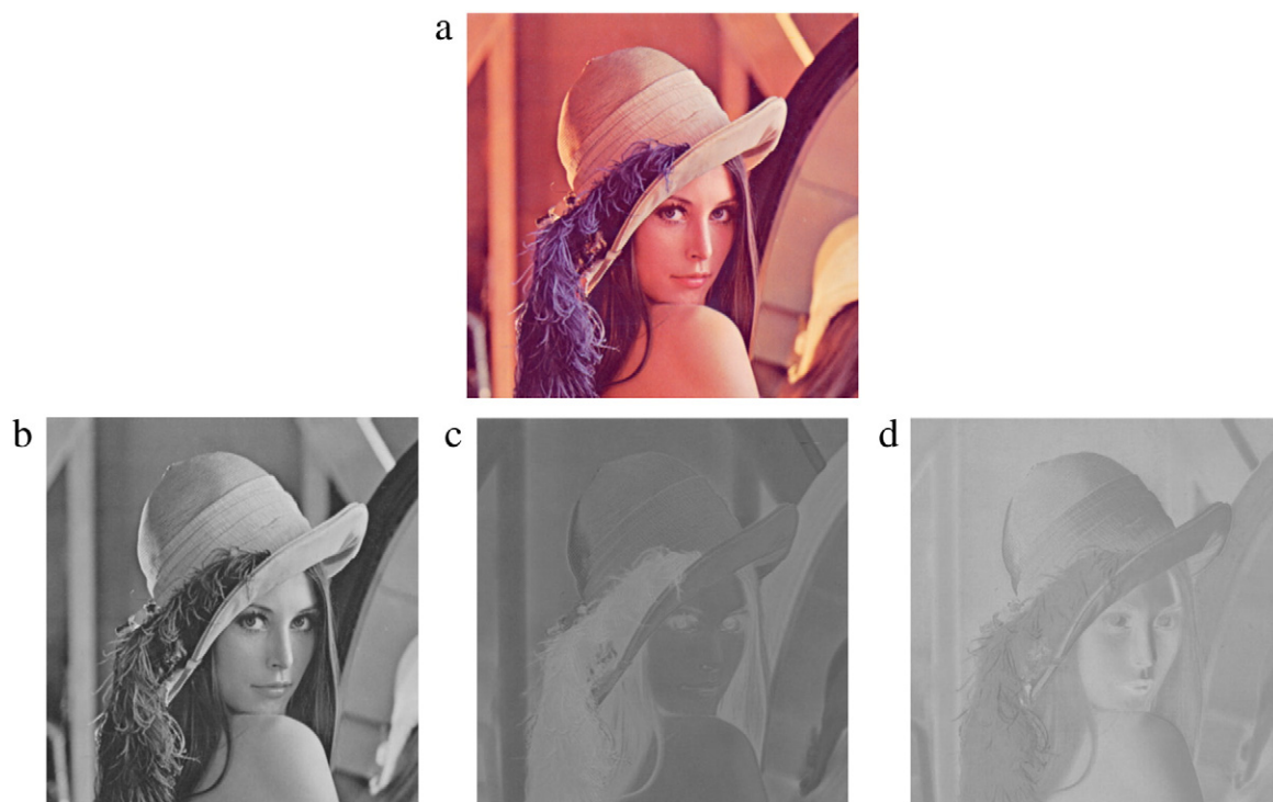
Fig. 2. An RGB image (a) and Y (b), U (c) and V (d) channels.
