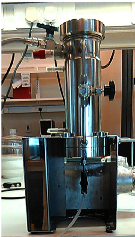
Fig. 1. Membrane filtration unit.
