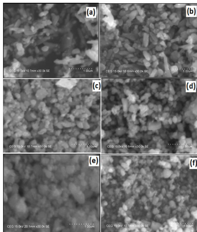
Fig. 2. SEM images of (a) 0 h, (b) 1 h, (c) 2 h, (d) 4 h, (e) 8 h, (f) 16 h ball milled iron(III) oxide particles.
