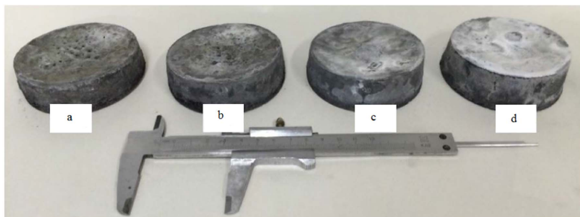
Fig. 1. The samples after SHS casting: a) Ni 41 Al 41 Cr 6 Co 12 b) Ni 41 Al 41 Cr 9 Co 9 c) Ni 41 Al 41 Cr 12 Co 6 d) Ni 41 Al 41 Cr 14 Co 4 .
