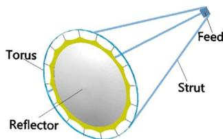
Fig. 1. Inflatable antenna.
