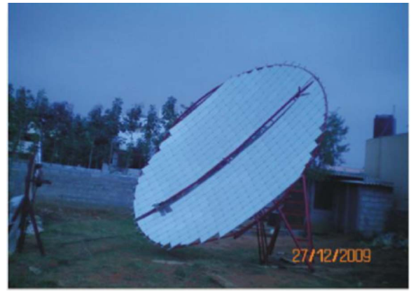
Fig. 2. A scheffler type solar reflector [16].
