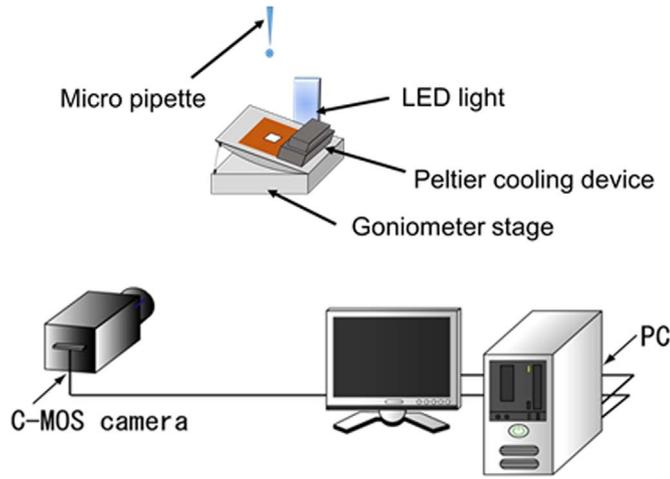
Fig. 1. Apparatus.
