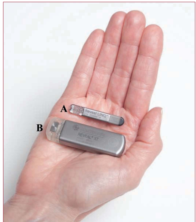
Figura 1. El monitor cardiaco insertable Reveal LINQ de Medtronic (A) ofrece monitorización del ritmo cardiaco, incluida la detección de fibrilación auricular, durante aproximadamente 3 años; presenta una reducción muy significativa de tamaño y una mejora del algoritmo de detección de fibrilación auricular con respecto a su predecesor, el Reveal XT (B).
