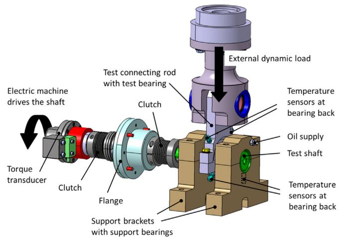
Fig. 3. Journal bearing test-rig at KS Gleitlager.
