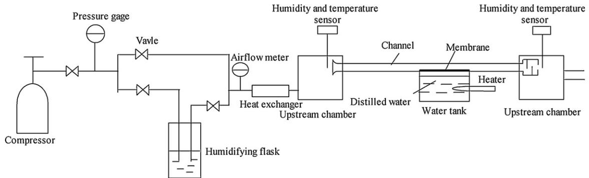
Fig. 1. Experimental apparatus.
