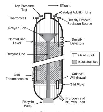
Fig. 1. LC-Finer<sup>SM</sup> schematic (Pjontek et al., 2015).
