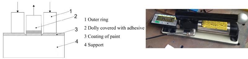
Fig. 1. Adhesion test (UNI EN ISO 4624).
