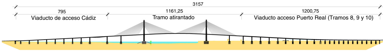
Figura 1. Alzado general del puente.
