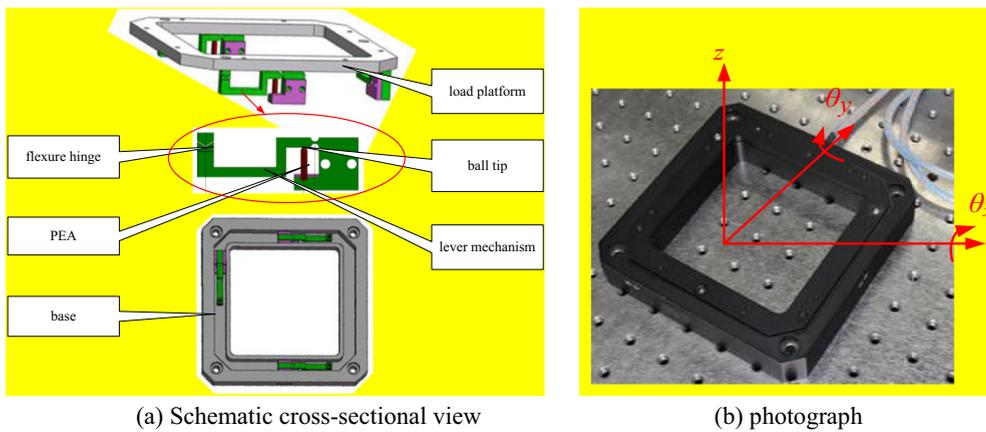
Fig. 1. 3-DOF ( $z$ - $\theta_x$ - $\theta_y$ ) piezo-stage.
