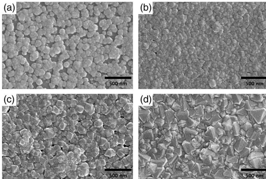
**Fig. 2.** Surface SEM images of CVD diamond films deposited for (a) 50 min, (b) 60 min, (c) 120 min, and (d) 200 min.
