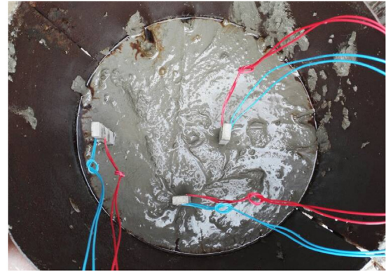
Fig. 2. Mortar test block pouring mold.
