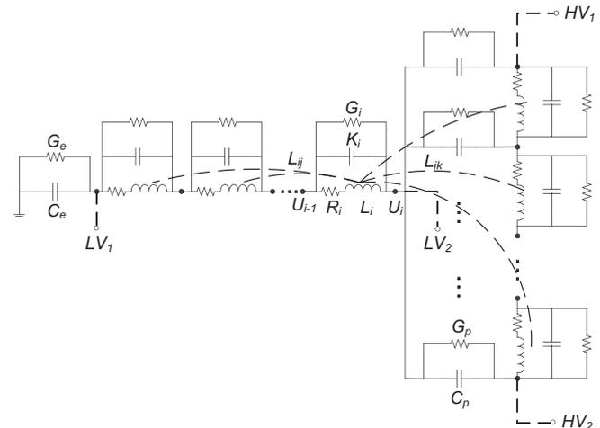
Fig. 2. Equivalent lumped parameter circuit.
