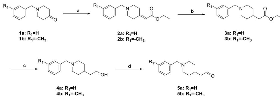
Scheme 1. Reagents and conditions: (a)  $(EtO)_2POCH_2CO_2Et$ ,  $K_2CO_3$ , THF; (b) Pd/C,  $H_2$ , MeOH; (c)  $LiAlH_4$ , THF; (d) Swern oxidation.
