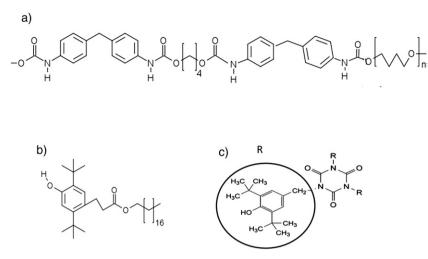
Fig. 1. Formula of a) polyurethane used b) Irganox 1076® and c) Irganox 3114®.
