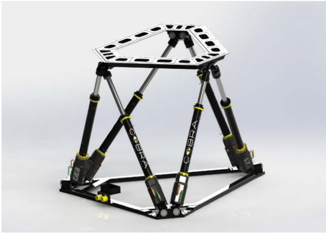
Figura 1: Plataforma robótica de movimiento. Fuente: Cobra Simulation®.
