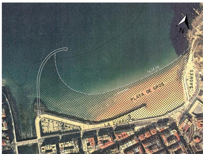
**Figura 2.** Línea de orilla. Nivel medio del mar (N.M.M.) previsto en [1] para la playa con la configuración de espigón curvo (alternativa C2).
