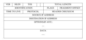
Figure 1 IPv4 packet format.
