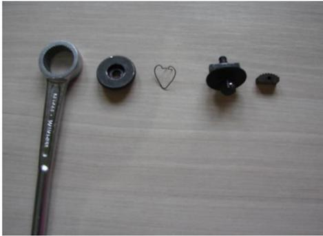
Fig. 1. Componentes da chave catraca.
