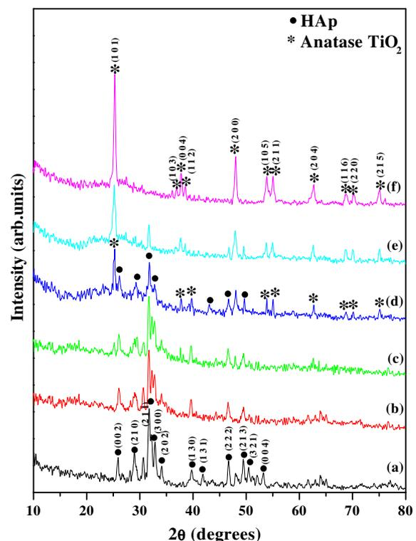
Fig. 1. XRD pattern of HAp/ $\text{TiO}_2$  nano composite films (a) pure HAp, (b) 10 vol.%  $\text{TiO}_2$ , (c) 20 vol.%  $\text{TiO}_2$ , (d) 50 vol.%  $\text{TiO}_2$ , (e) 80 vol.%  $\text{TiO}_2$  and (f) pure  $\text{TiO}_2$ .
