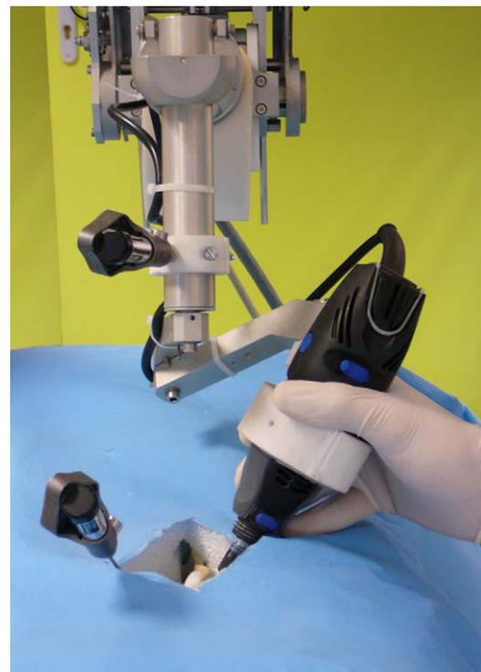
Fig. 2. Prise simultanée de l'outil de fraisage par le chirurgien et le cobot.
