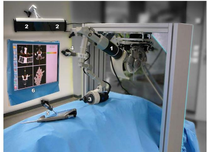
Fig. 1. Le système complet comprend les éléments suivants : 1 : le cobot réalisé par Haption ; 2 : les caméras fournies par SQI ; 3 : l'outil ; 4 : la cible associée au robot ; 5 : le palpeur et sa cible ; 6 : l'interface graphique conçue par SQI.
